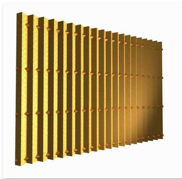
Figure 4 : Animation géométrique du panneau Wenus par taillage localisé et insert d'un chevron de remplissage
